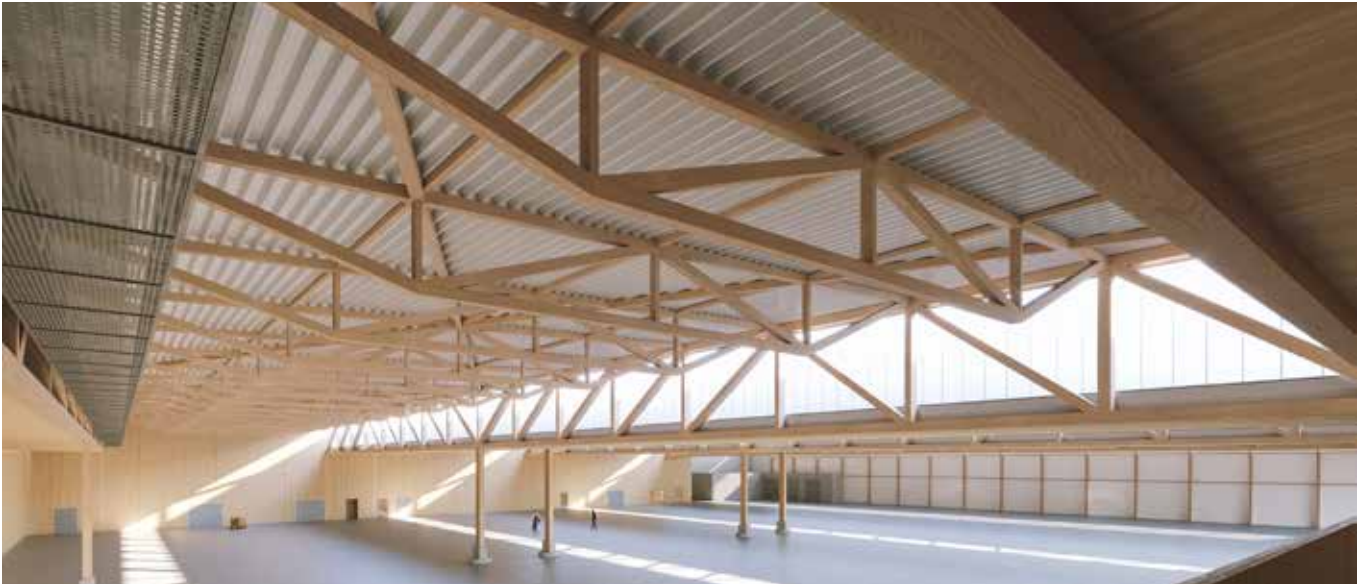
Bild 1: Die 1,50 m hohen Neben-Fachwerkträger überspannen die Hallenschiffe mit 18,30 m und sind zwischen den 82 m langen Haupt-Fachwerkträgern eingehängt. (Visualisierung: HK Architekten)
