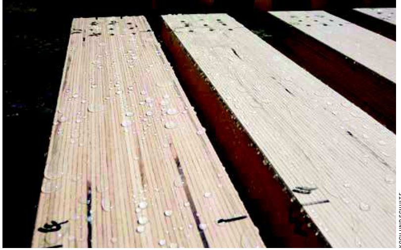
Beschichtete BauBuche-Prüfkörper nach starkem Regenfall auf dem Freigelände der Firma Pollmeier
