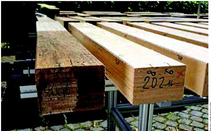
Unbeschichtete und beschichtete BauBuche-Prüfkörper im Vergleich nach fast sechsmonatiger Freibewitterung
