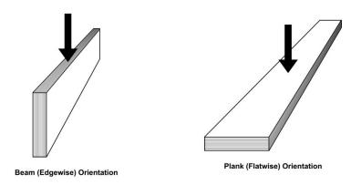
FIGURE 1—BENDING LOAD ORIENTATION
