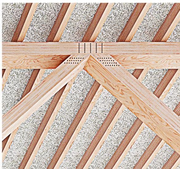
**Comparaison de poutres en treillis en BauBuche, en épicea et en bois lamellé.** BauBuche permet, en raison de sa grande résistance à traction et compression, de réaliser des barres nettement plus étroites pour une portée et une résistance identiques.
