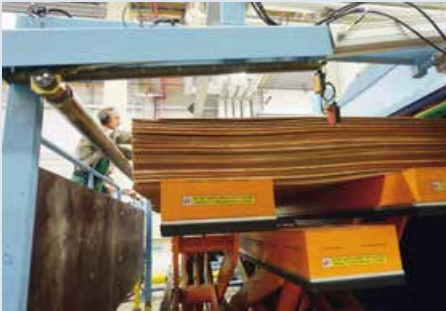
▲ Nach dem Abschälen warten die Buchenfurniere auf den Weitertransport in den Trockner
