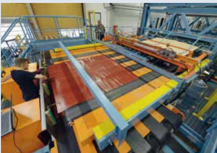
▲ Die Buchenfurniere werden mit Leim bestrichen, geschichtet und zur Controll-Pressen...
