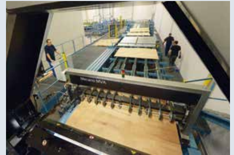
▲ Die Furniere durchlaufen einen Scanner, der zur Qualitätssortierung dient
