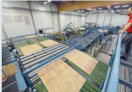
▲ Die geringe Dicke ermöglicht kurze Trocknungszeiten: Furniere beim Verlassen des Trockners
