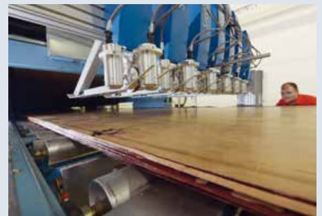
▲ Die fertige Baubuche-Platte (hier beim Verlassen der Presse) wird abschließend zugeschnitten
