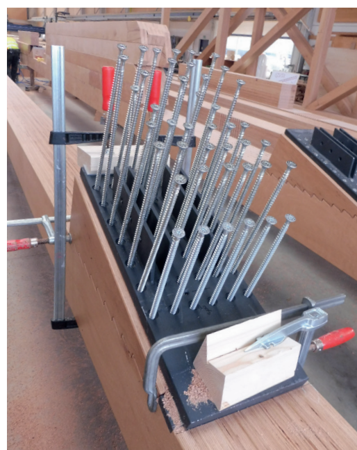
Atelier de production de SWG – 12 mm vis à filetage intégral
