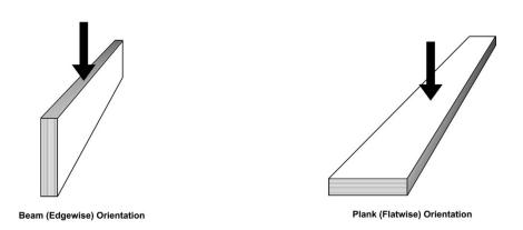
FIGURE 1—BENDING LOAD ORIENTATION
