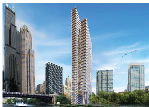
Chicago River Beech Tower, projet d'un gratte-ciel de 80 étages avec ossature en bois de feuillus, projet de l'Université de Cam- bridge, Perkins + Will et Thornton Thomasetti
